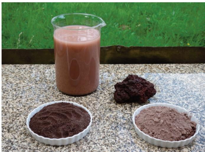
**Abb. 1, Lavagestein, Lavasand, Lavamehl, Lavamehl in Regenwasser aufgeschlämmt**
