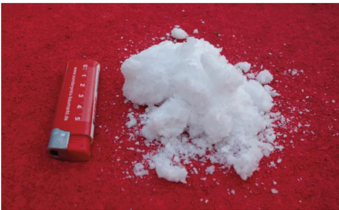
**Abb. 7, Kieselsäure-„Glasschaum“ aus der Reaktion von Wasserglas und Säure.**
