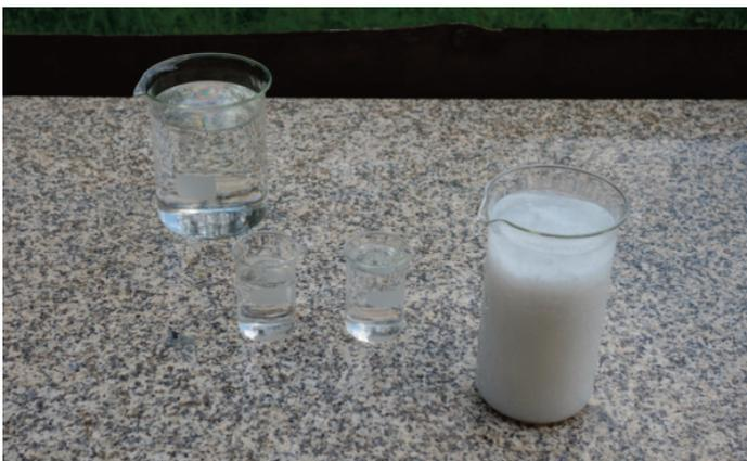
**Abb. 8, Herstellung eines Kolloids aus weißem Calcium-Silikat (rechts) aus Wasserglas, Regenwasser und Ca-Nitrat-Lösung**
