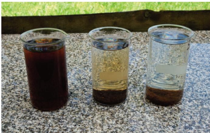
**Abb. 6, Reaktion der Kolloidlösung bei Zugabe von sauren oder calciumhaltigen Lösungen**
